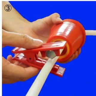
容器深度に合わせて付属のホースカッターでパイプを切断します。
