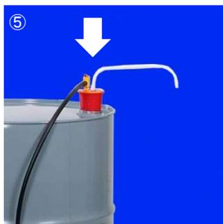
容器内の液が飛散しないよう④で接続済みの接液パイプ吸引側を容器口へゆっくと挿入し、PVC 栓を容器口へしっかりと押し込み固定します。
