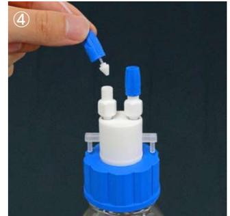
④ ボトルキャップへ取り付けられたコネクタボディに③のキャップを取り付けます。
