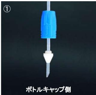
① 斜めに切断したチューブをキャップ、コーンの順に通します。
