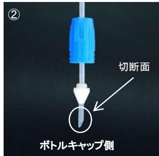
② コーンがチューブ切断面より中に入るまで押し込みます。
