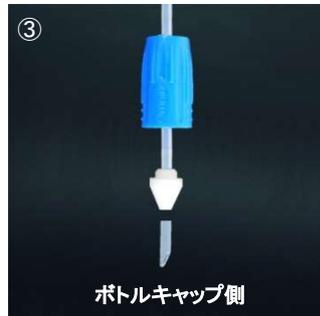
③ コーンの先から出たチューブを直角に切断します。
